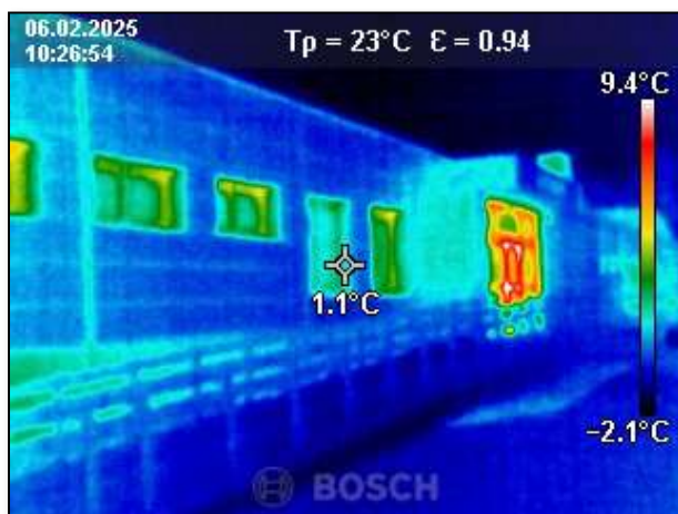
Fot. 98. Zdjęcie termowizyjne i cyfrowe ściany zewnętrznej od strony wschodniej, zaobserwowano największe straty w miejscu występowania stolarki okiennej, drzwi wejściowych bonii elewacyjnych oraz w strefie cokołowej, z uwagi na mniejszą grubość ocieplenia niż na ścianie, ponad wskazane nie zaobserwowano miejsc o zwiększonych stratach ciepła, tzw. mostków termicznych, rozkład temperatury jest równomierny,
