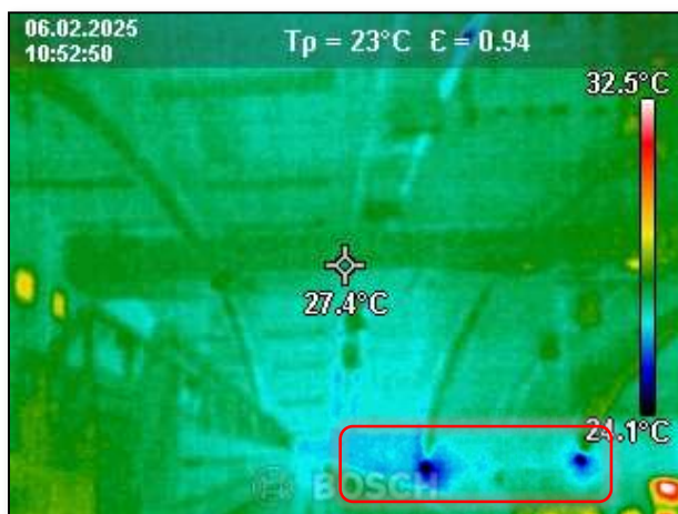
Fot. 105. Na zdjęciach termowizyjnych przedstawiono rozkład temperatury we wnętrzu pomieszczenia basenu, rozkład temperatury na pokryciu dachowym jest równomierny, największe straty zaobserwować można w miejscu podparcia dźwigarów na ścianie zewnętrznej,
