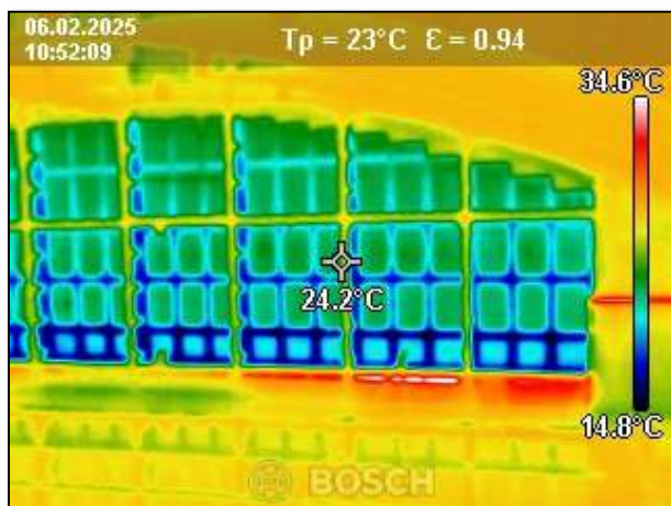
Fot. 108. Na zdjęciach termowizyjnych przedstawiono rozkład temperatury we wnętrzu pomieszczenia basenu, największe straty zaobserwować można w miejscu podparcia dźwigarów na ścianie zewnętrznej oraz na fasadzie metalowo- szklanej, potwierdza się wynik badania fasady z zewnątrz – większe straty ciepła widoczne są na elementach konstrukcji, niż na szybach
