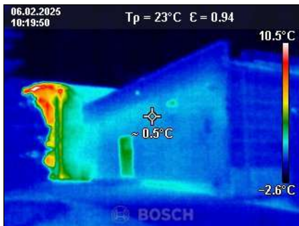
Fot. 104. Zdjęcie termowizyjne i cyfrowe ściany południowej, widać znaczącą różnicę w stratach ciepła w odniesieniu do ścian zewnętrznych i fasady, straty przez fasadę są znacząco większe,
