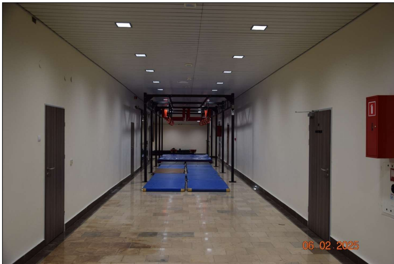
Fot. 236. Widok urządzeń do ćwiczeń umieszczonych w korytarzu, które wprowadzają dodatkowe obciążenia dynamiczne prowadzące do pęknięcia ścian działowych. Brak wpływu na bezpieczeństwo konstrukcji nośnej. (fot. Rafał Fit)
