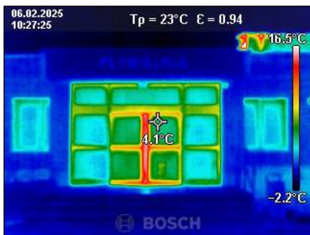
Fot. 97. Zdjęcie termowizyjne i cyfrowe ściany zewnętrznej od strony wschodniej- wejście do obiektu, zaobserwowano największe straty w miejscu występowania stolarki okiennej i drzwi wejściowych, na zdjęciu z kamery termowizyjnej widać, że przez nieszczelności drzwi dochodzi do ucieczki ciepłego powietrza z wnętrza obiektu, sama fasada wejściowa wychłodzona jest do temperatury około 4,1°C, przy temperaturze zewnętrznej 2,2 °C
