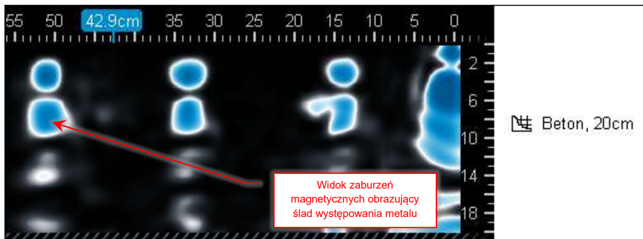
Fot. 18. Obraz ferromagnetyczny występowania zbrojenia w z detektora BOSCH Professional D-Tect 200 C. (fot. Rafał Fit)
