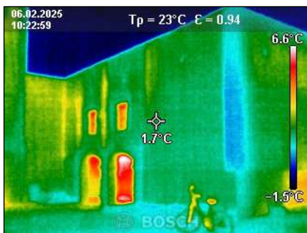
Fot. 101. Zdjęcie termowizyjne i cyfrowe ściany zachodniej – narożnik południowo-zachodni, zaobserwowano największe straty w miejscu występowania elementów wentylacji, stolarki okiennej i drzwiowej, ponad wskazane nie zaobserwowano miejsc o zwiększonych stratach ciepła, tzw. mostków termicznych, rozkład temperatury jest równomierny,
