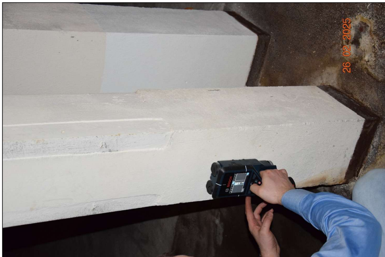
Fot. 16. Skanowanie słupów celem potwierdzenia ilości zbrojenia i grubości otuliny. (fot. Rafał Fit)
