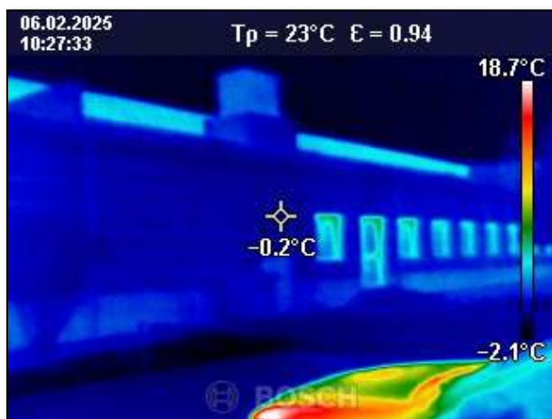
Fot. 96. Zdjęcie termowizyjne i cyfrowe ściany zewnętrznej od strony wschodniej, największe straty ciepła uwidaczniają się w miejscu występowania stolarki okiennej i drzwi, ponad wskazane nie zaobserwowano miejsc o zwiększonych stratach ciepła, tzw. mostków termicznych, rozkład temperatury jest równomierny,
