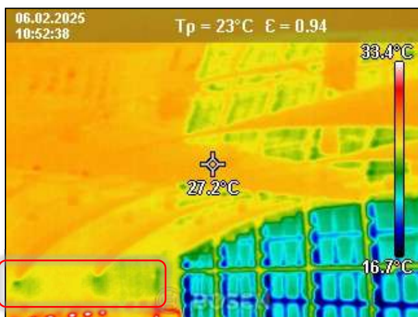
Fot. 106. Na zdjęciach termowizyjnych przedstawiono rozkład temperatury we wnętrzu pomieszczenia basenu, rozkład temperatury na pokryciu dachowym jest równomierny, największe straty zaobserwować można w miejscu podparcia dźwigarów na ścianie zewnętrznej oraz na fasadzie metalowo- szklanej,
